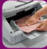
Per una ancor maggiore affidabilità, negli scanner sono incorporati sensori che rilevano la presenza di punti metallici, in modo da evitare possibili danni ai documenti. Una modalità di alimentazione manuale continua, inoltre, permette di controllare agevolmente l'alimentazione quando si maneggiano documenti difficili. Le guide laterali bloccabili della carta assicurano a loro volta scansioni produttive e senza problemi.
